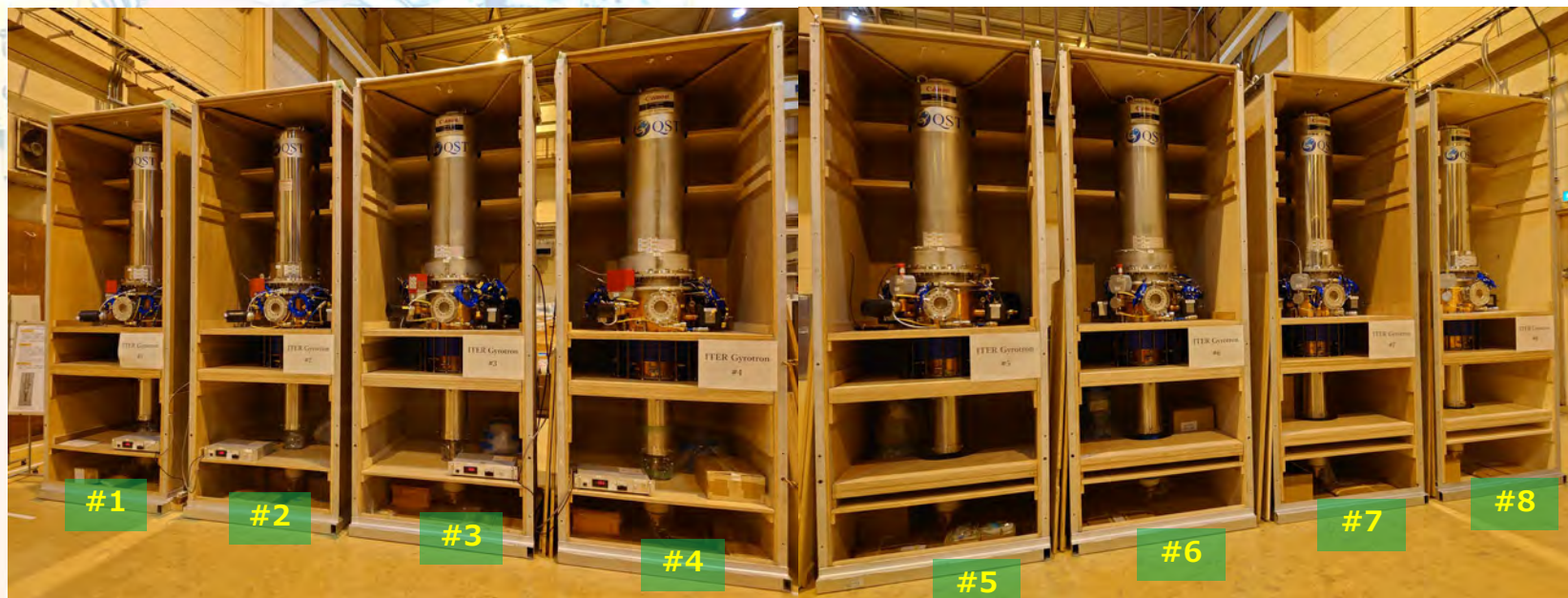
JADA 担当の大電力ミリ波発振装置 (170GHz、1MW、定常)
