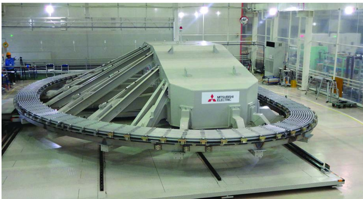
日本での ITER-TF コイル巻線製作の様子(提供:三菱重工/三菱電機)
