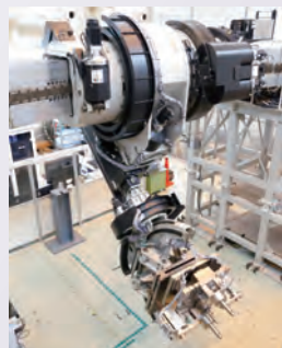
核融合炉保守点検用のロボットアーム
