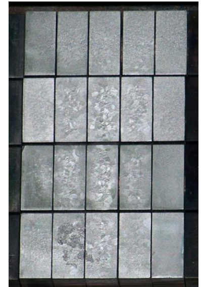
20 MW/m 2 、1000 サイクル照射後の受熱面（タングステン）
