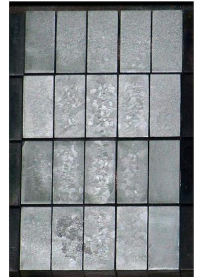
20 MW/m<sup>2</sup>、1000 サイクル照射後の受熱面 (タングステン)
