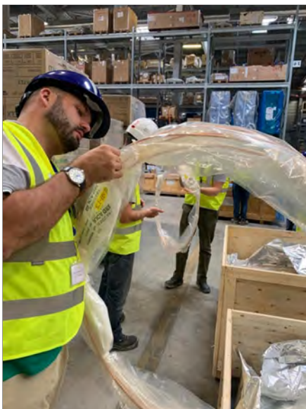
図4 MIケーブルの目視検査
