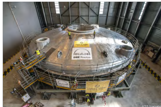
図 4 クライオスタット上蓋：現地溶接完了
