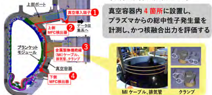
図2 ITER向けマイクロフィッションチェンバー説明図
