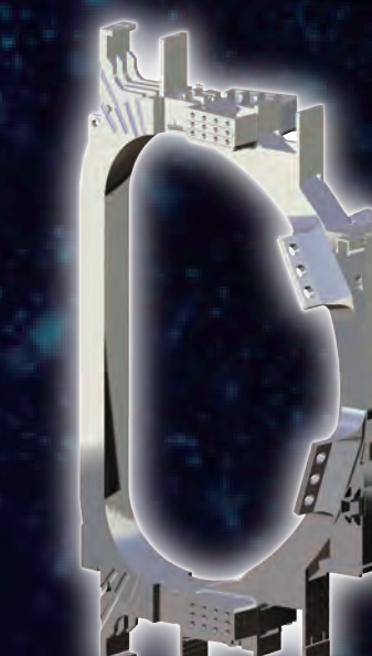
■超伝導コイル プラズマを閉じ込めるための磁場を作る巨大な電磁石
