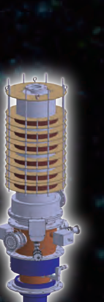
■高周波加熱装置(ジャイロトロン) プラズマの温度を上げる高周波加熱装置
